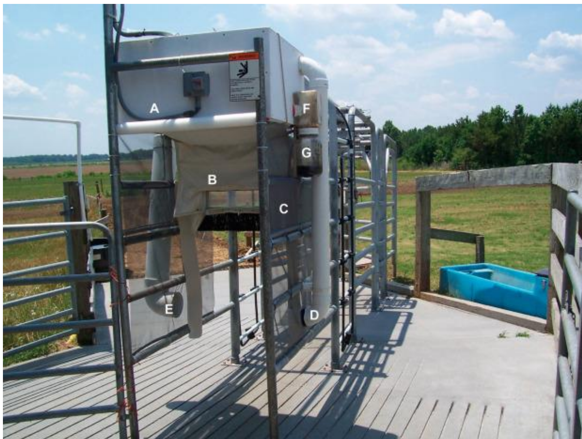
Figure 9 : Photographie d'un piège à mouches par aspiration monté sur un couloir de sortie au Center for Environmental Farming Systems (Goldsboro, Caroline du Nord). Les composants comprennent : (A) boîtier du caisson d'aspiration, (B) entrée d'aspiration supérieure, (C) grille en fibre de verre, (D) orifice d'évacuation de la pression de l'air, (E) orifice d'aspiration inférieur, (F) chambre de collecte des mouches et (G) réceptacle des mouches mortes (Denning SS et al., 2014).
